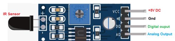
Fig3.4 : Flame sensor Module
